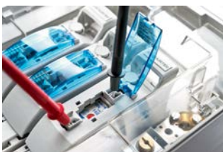
NH-Sicherungslasttrennschalter Spannungsprüfung bei NH-Sicherungen mit nicht isolierten Griffflaschen durch aufklappbares Fenster möglich
